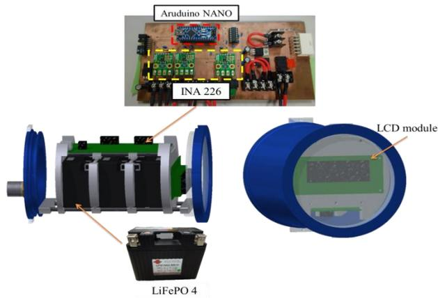
Fig.10 Battery module
